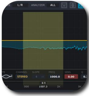
O modo de varredura de banda estreita é ativado pelo clique esquerdo do mouse + tecla ctrl na área livre da visão do espectro. A frequência é alterada movendo o mouse para a esquerda/direita, o Q do filtro é alterado movendo o mouse para cima/baixo.
