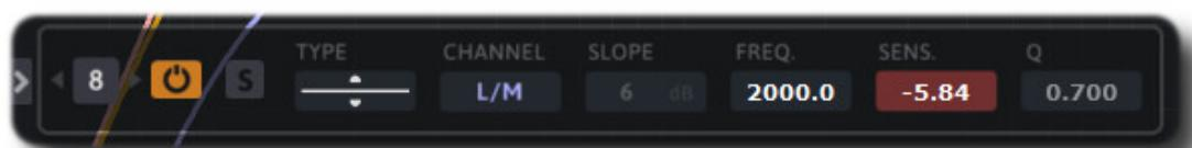
Pre-filter controla a alimentação do sinal no equalizador dinâmico. Você pode retirar partes do espectro (não processadas pelos equalizadores dinâmicos) ou reforçar (mais processado pelo equalizador dinâmico).
